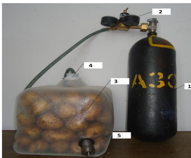
Рисунок 2 - Процесс хранения картофеля и регулирование газовой среды в полиэтиленовой емкости
