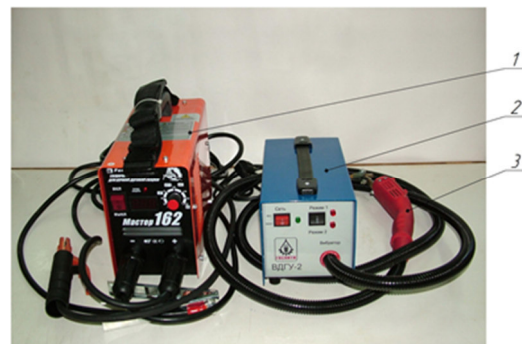
Рисунок 1 – Комплект оборудования ВДГУ-2: 1 – источник тока; 2 – пульт управления; 3 – вибратор
