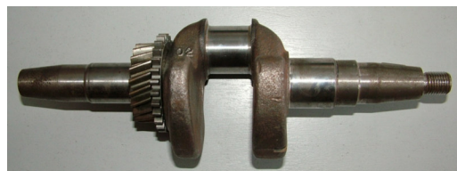
Рисунок 2 – Коленчатый вал малогабаритного двигателя, восстановленный электродуговой металлизацией с аэрозольным флюсованием
