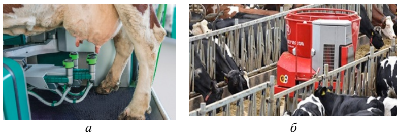
Рисунок 1 – Ресурсосберегающие технологии доения и кормления: а – релятивная система нахождения сосков вымени; б – автоматическая система кормления скота
