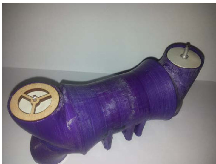
Рисунок 7 - Обратные клапаны и воздуховода на выходе диффузора
