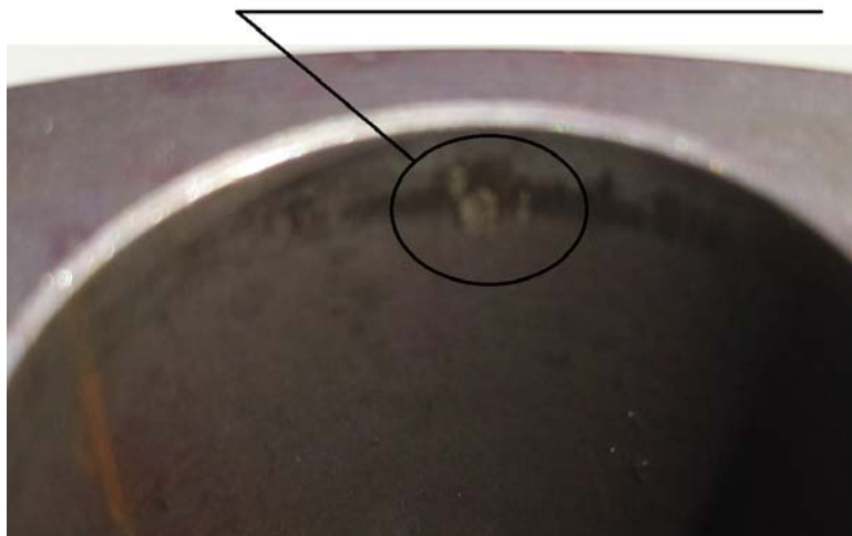
Рисунок 2 – Изношенный цилиндр корпуса плунжеров
