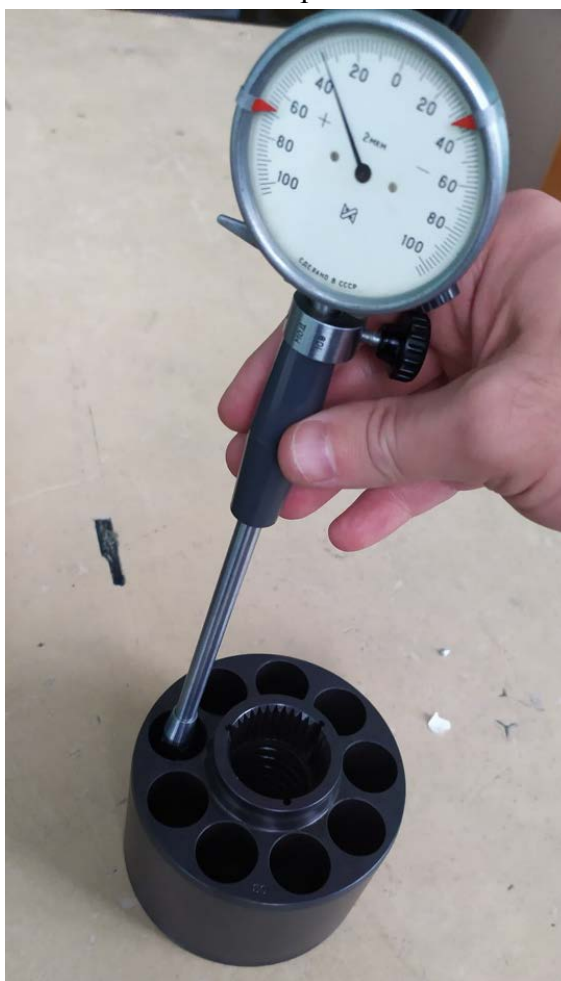
Рисунок 1 – Измерение плунжера насоса Danfoss FR-L-090C
