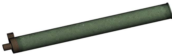
Рис. 12. Сеточная модель вихревого холодильника
