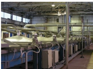
Рисунок 2 – Паровая конвейерная сушилка СПК-4Г-45 ( a ), инфракрасная конвейерная сушилка ( б )
