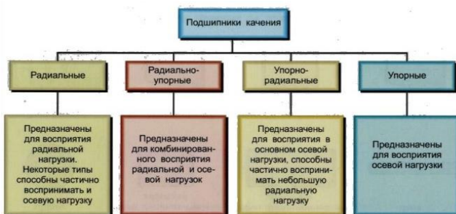
Рисунок 2 – Классификация подшипников качения по виду воспринимаемой нагрузки
