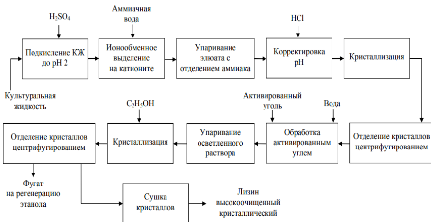
Рисунок 1 – Технологическая схема получения кристаллического лизина
