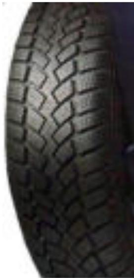
Рисунок 2.21 – Протектор универсальной (всесезонной) шины.
