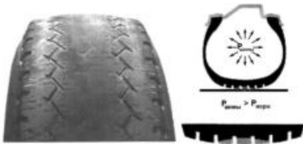
Рисунок 2.28 – Износ средней части протектора из-за езды с чрезмерной величины давления воздуха в шине.
