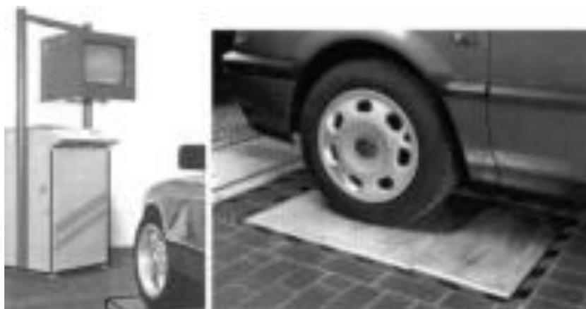
Рисунок 3.58 – Стенд испытаний амортизаторов и подвески колес методом колебаний опорной платформы.
