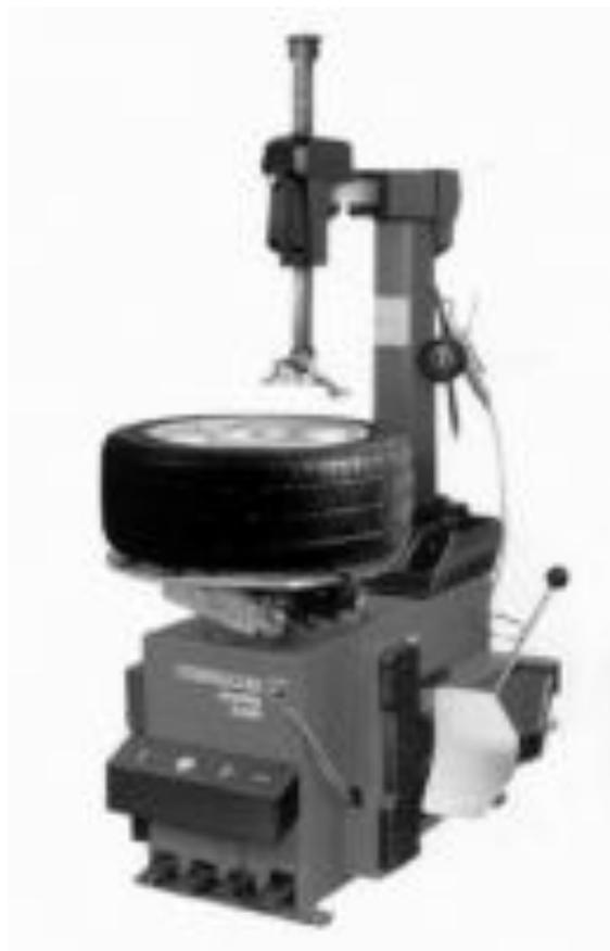
Рисунок 2.36 – Шиномонтажный стенд с поворотным столом.
