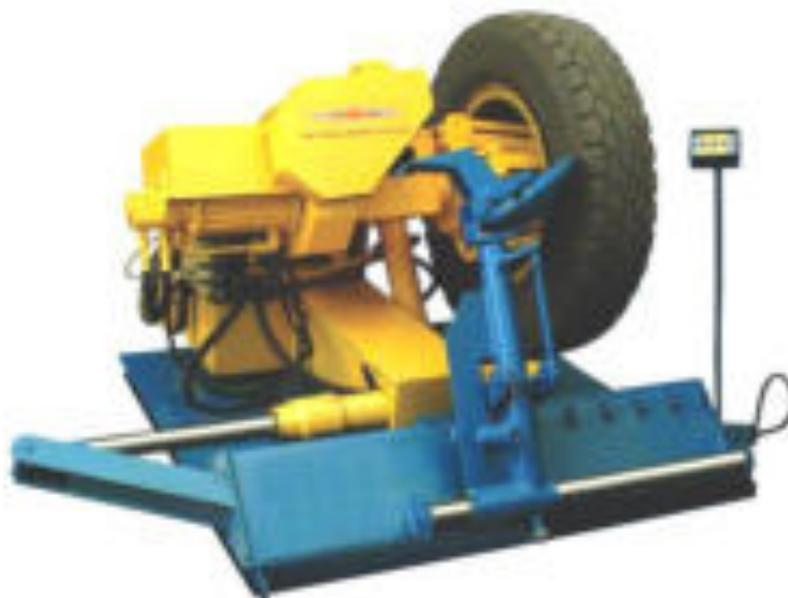
Рисунок 2.37 – Стенд для разбортовки колес грузовых автомобилей.
