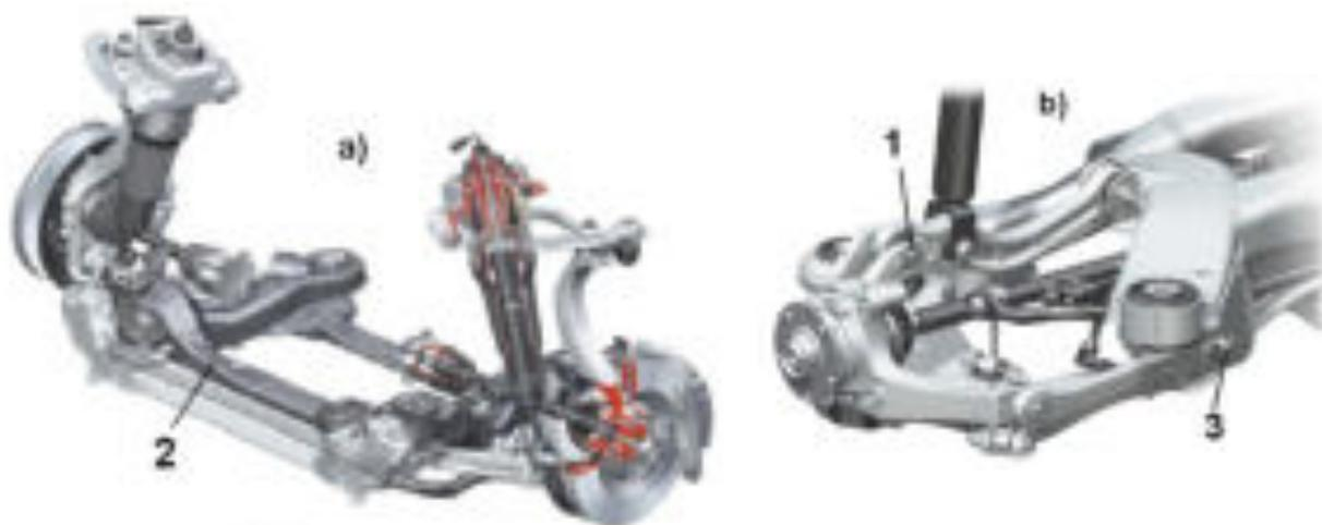
а – передняя ось автомобиля; b – задняя ось автомобиля; 1 – эксцентриковый болт регулировки развала колеса задней оси; 2 – подрамник передней оси; 3 – эксцентриковый болт регулировки схождения колеса задней оси.
