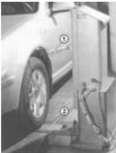
1 – Рычаг изменения колебаний кузова; 2 – Платформа подъема и сброса автомобиля.
