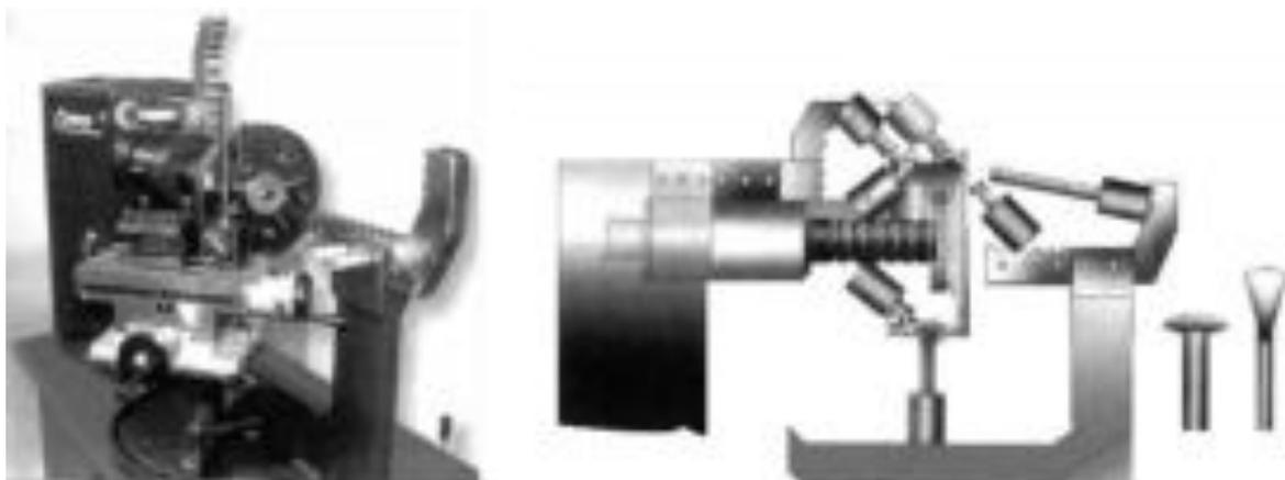
Рисунок 2.41– Стенд для правки дисков колес автомобилей.
