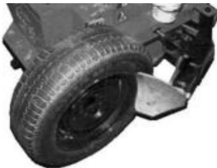
Рисунок 2.35 – «Плуг» для отделения бортов шины от закраин обода.
