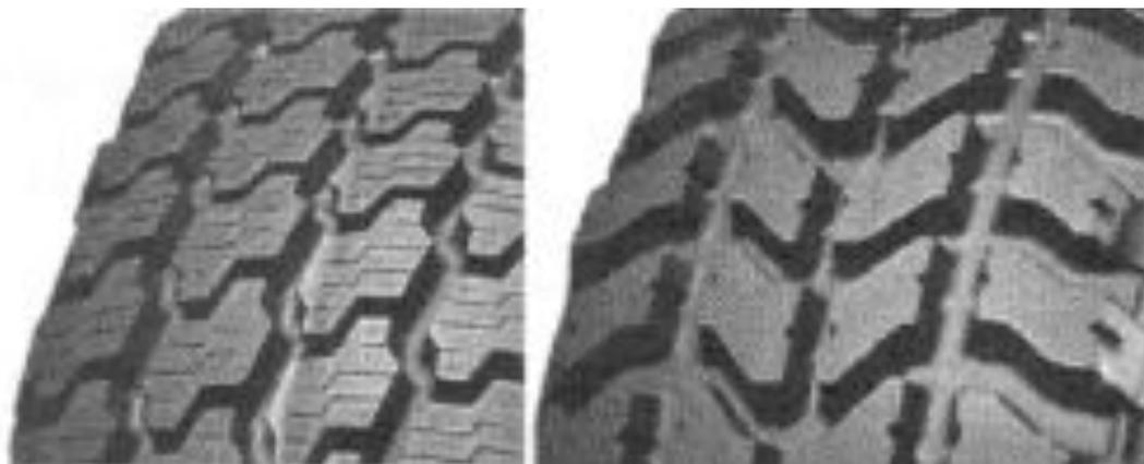
Рисунок 2.16 – Рисунок протектора шин для автомобилей повышенной проходимости.
