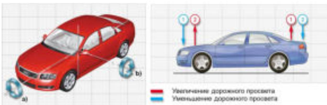
Рисунок 3.22 – Опрокидывающие моменты сил, действующие на автомобиль в продольной (b) и поперечной (a) плоскостях.
