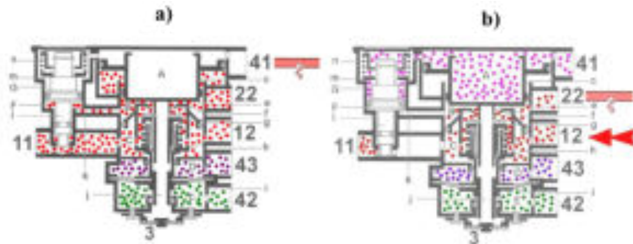
Рисунок 2.27 – Работа клапана управления тормозами прицепа при нарушении герметичности управляющего контура рабочей тормозной системы а и разрыва линии управляющего давления б.
