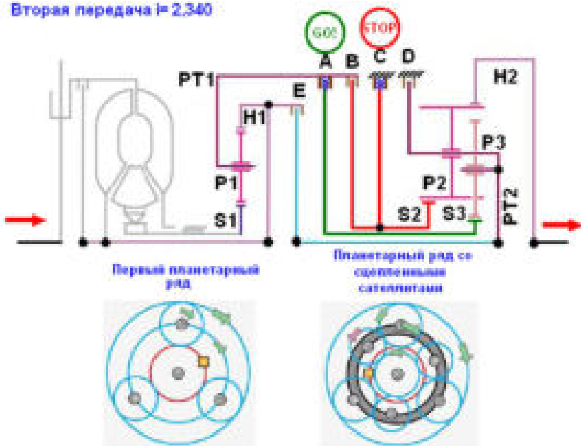
Рисунок 3.109 – Работа АКПП, собранной по схеме Лепелетье на второй передаче.
