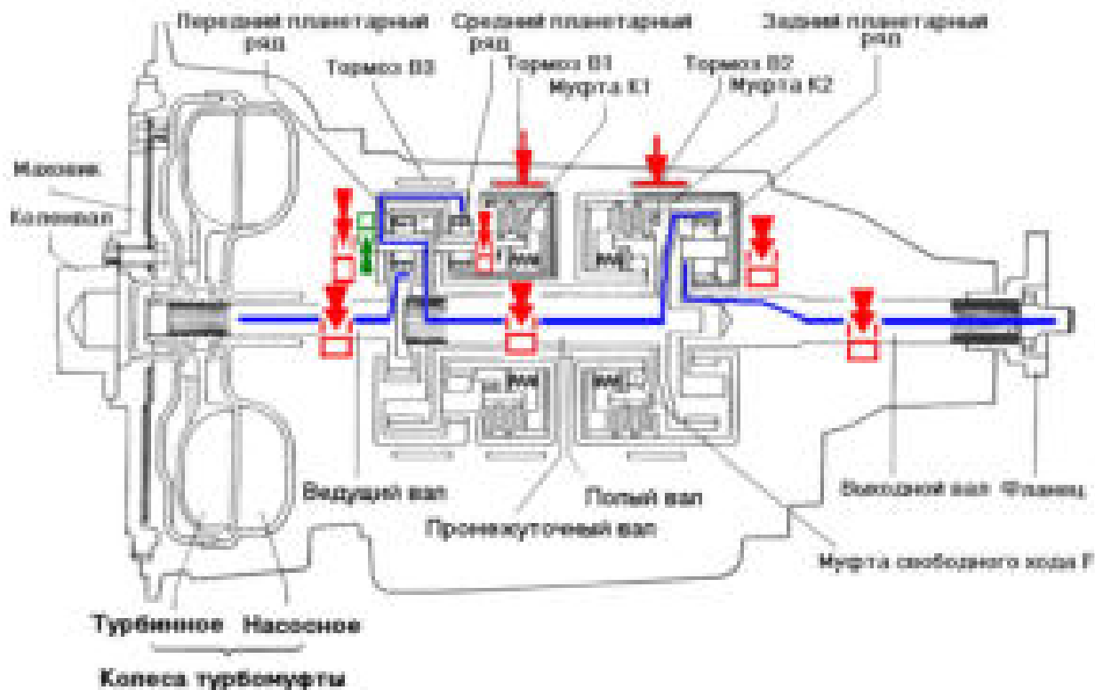
Рисунок 3.92 – Схема АКПП Mercedes-Benz 722-01. Вторая передача.
