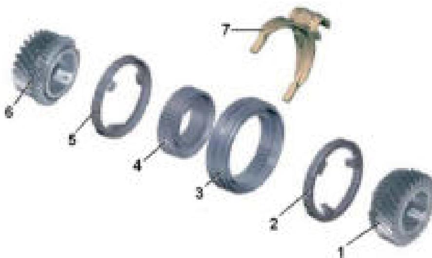
Рисунок 1.21 – Коробка передач с усиленными синхронизаторами.
