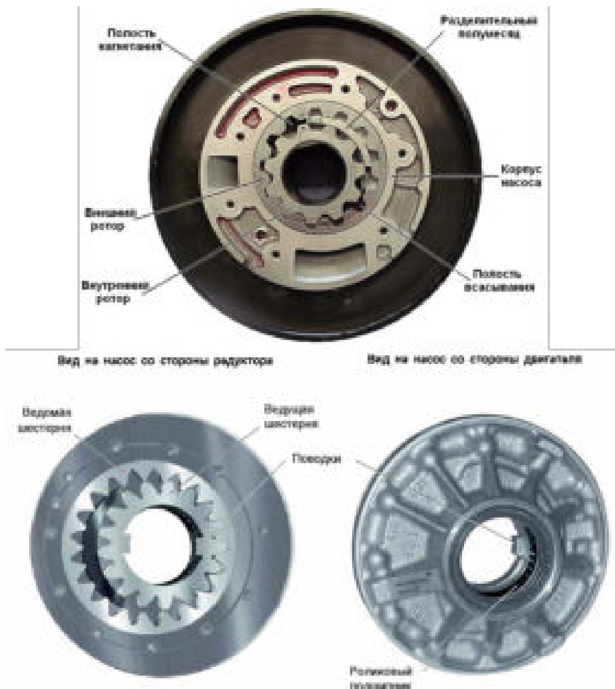
Рисунок 3.49 – Шестеренчатый насос.
