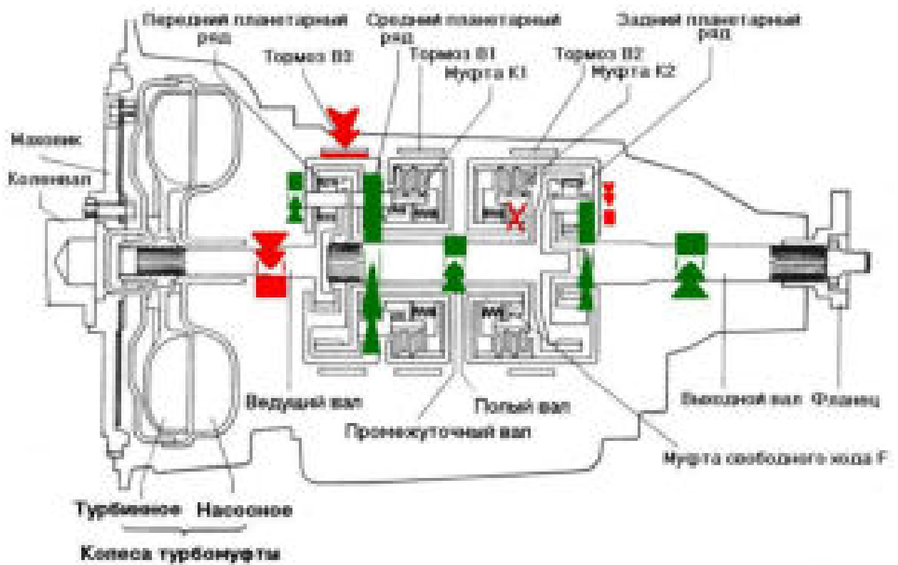
Рисунок 3.98 – Схема АКПП Mercedes-Benz 722-01. Передача заднего хода.
