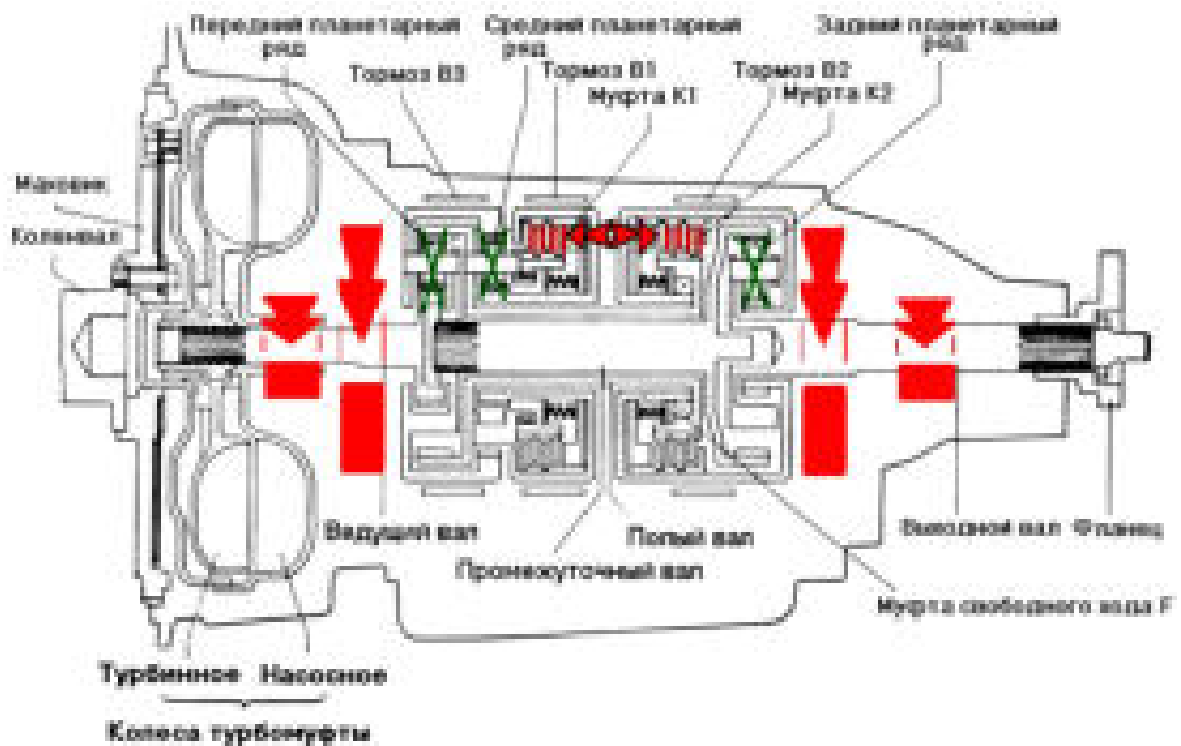
Рисунок 3.96 – Схема АКПП Mercedes-Benz 722-01. Четвертая передача.
