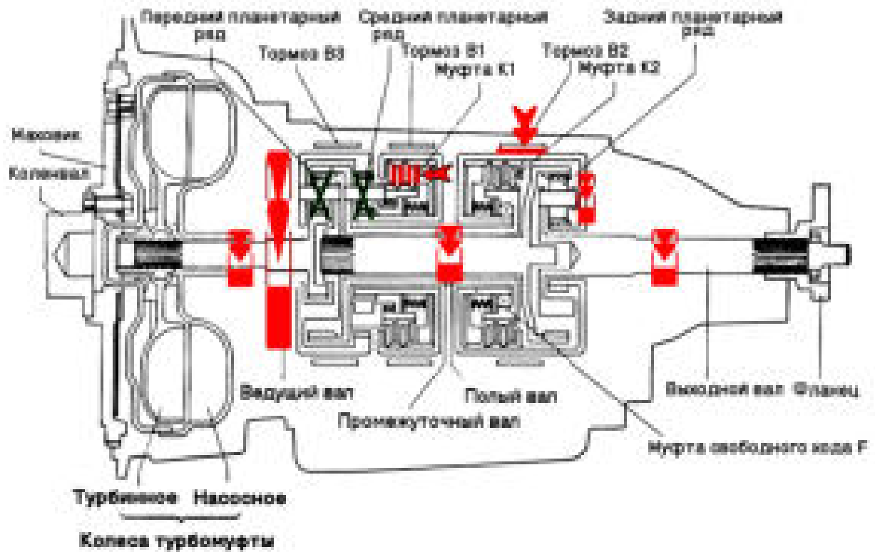
Рисунок 3.94 – Схема АКПП Mercedes-Benz 722-01. Третья передача.
