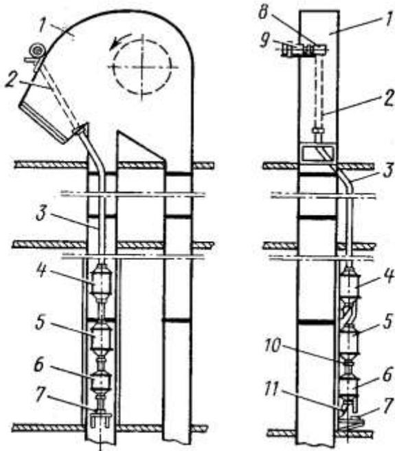
**Рисунок 2 – Схема установки пробоотборника РЗ-УПТ с делительной колонкой РЗ-УДК в норрии**
