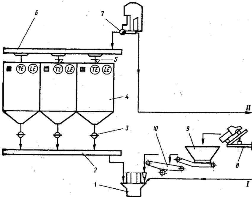
**Рисунок 31 – Механизированное зернохранилище модульного типа вместимостью 500 т:**
