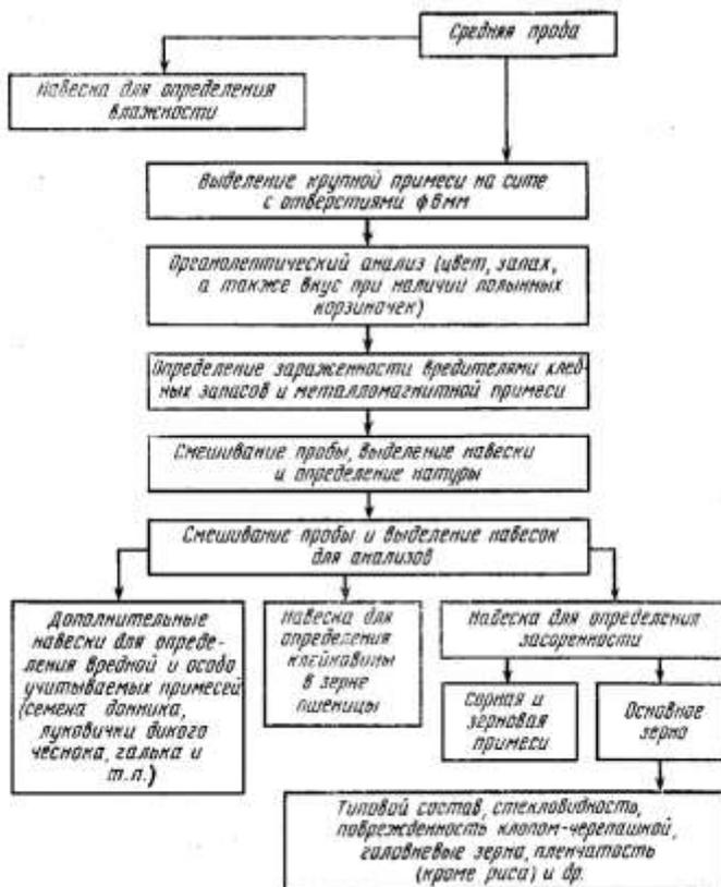
Рисунок 6 – Схема проведения анализов средней пробы зерна
