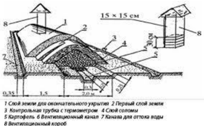
Рисунок 14 – Хранение картофеля в буртах
