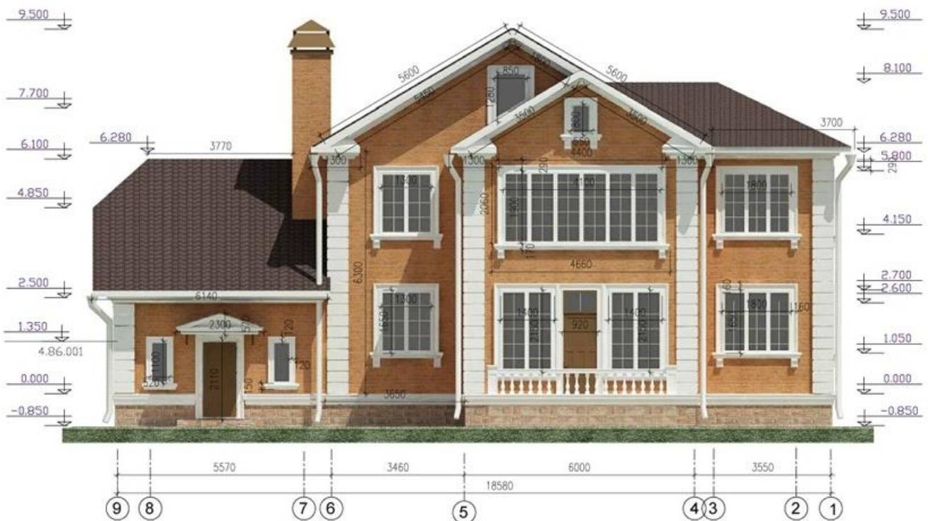
Рис.5. Пример графического выполнения фасада здания.
