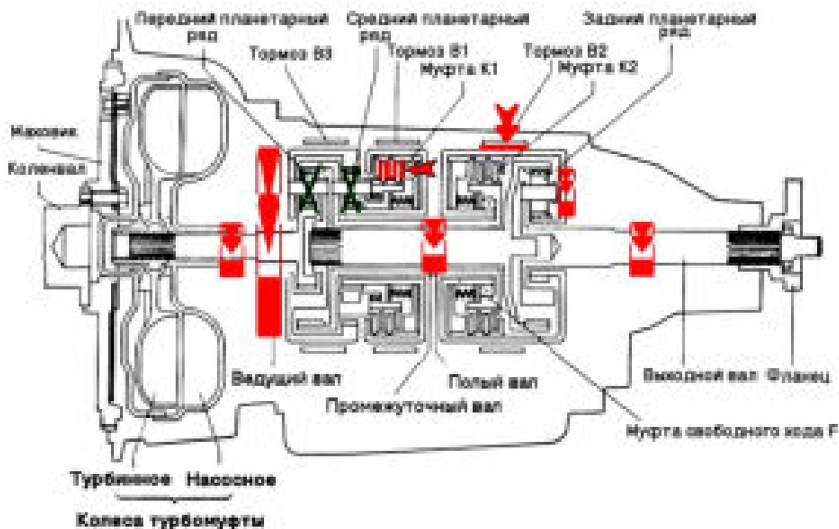
Рисунок 1.94 – Схема АКПП Mercedes-Benz 722-01. Третья передача.
