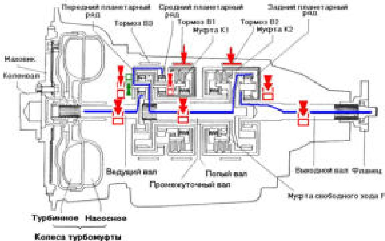
Рисунок 1.92 – Схема АКПП Mercedes-Benz 722-01. Вторая передача.
