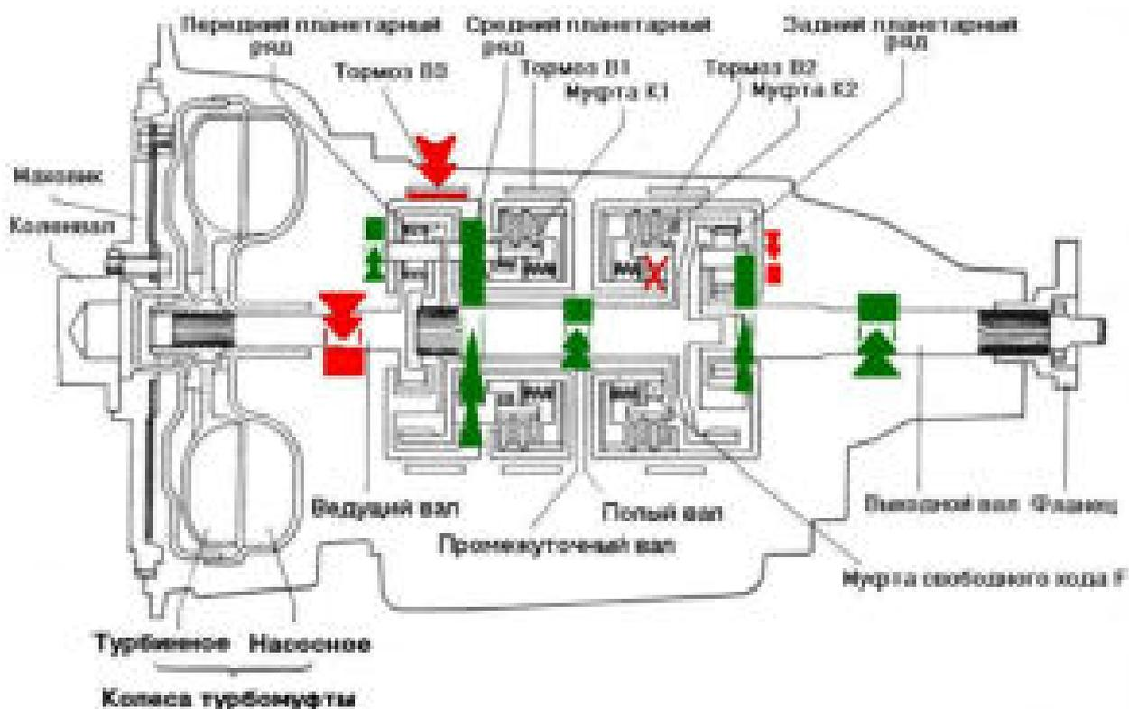
Рисунок 1.98 – Схема АКПП Mercedes-Benz 722-01. Передача заднего хода.
