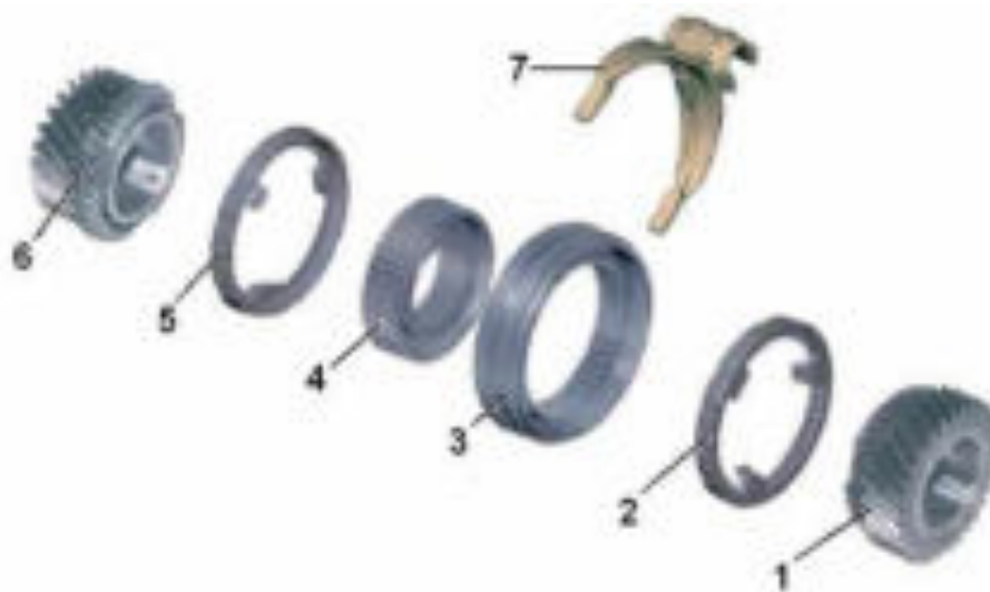
Рисунок 1.21 – Коробка передач с усиленными синхронизаторами.
