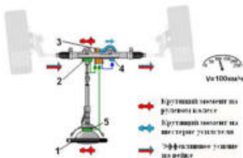
Рисунок 1.30 – Действие рулевого усилителя при плавном маневрировании при движении вне населенных пунктов.
