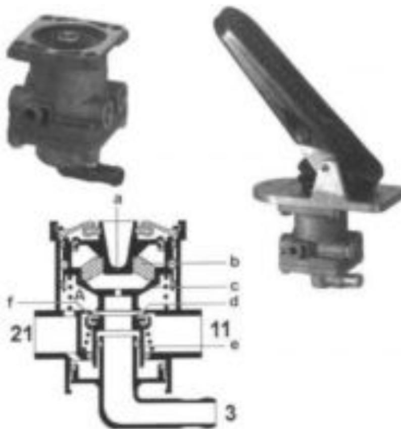
3 – выпуск воздуха в атмосферу; 11 – линия поступления сжатого воздуха; 21 – линия подачи воздуха к тормозным камерам; А – подпоршневая полость; а – толкатель; b – упругий элемент; с – поршень-толкатель; d – выпускной кольцевой канал; e – клапан; f – кольцевой канал подачи воздуха.
