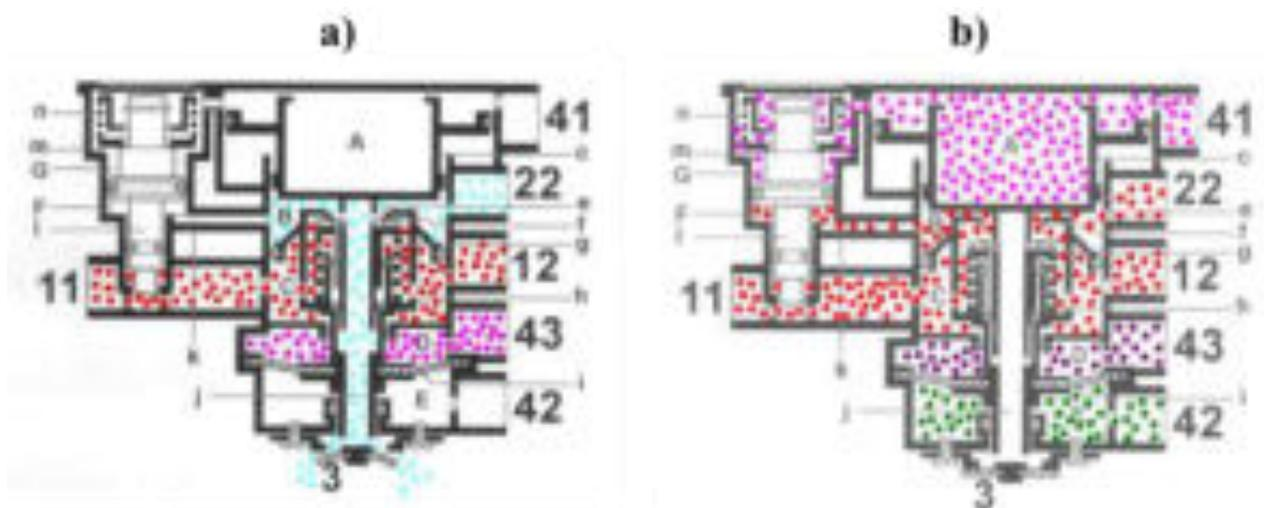
Рисунок 1.26 – Работа клапана управления тормозами прицепа (а – режим работы при движении автомобиля без торможения; б – режим работы при торможении автопоезда рабочей тормозной системой).
