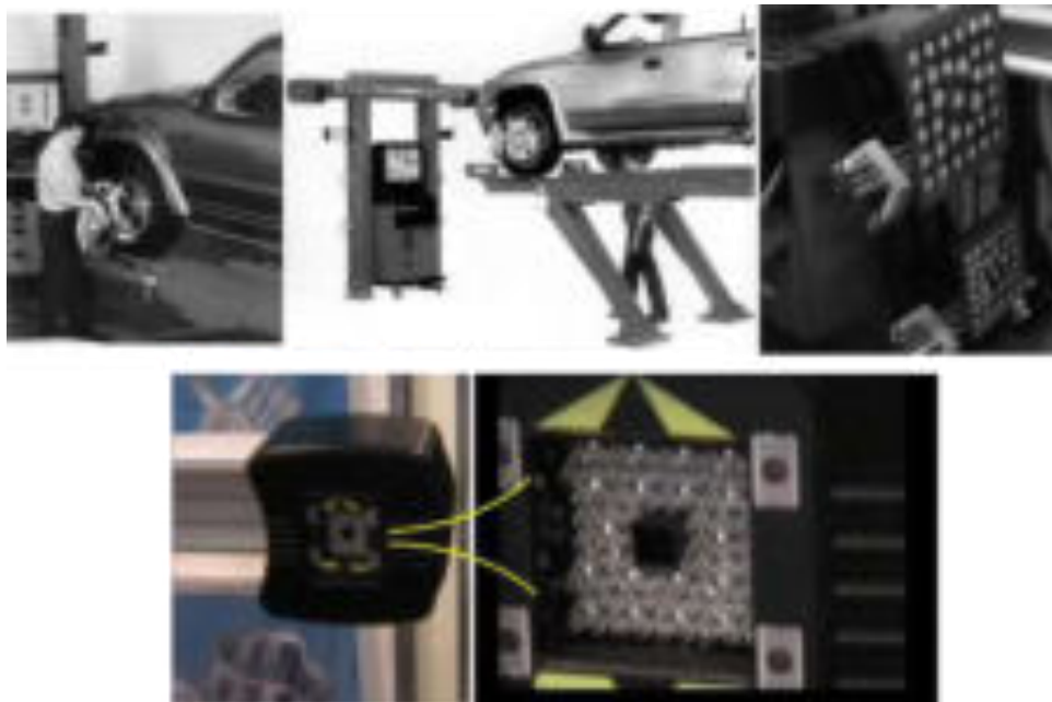
Рисунок 1.84 – Измерение с помощью построения трехмерных математических моделей (3D – технология).
