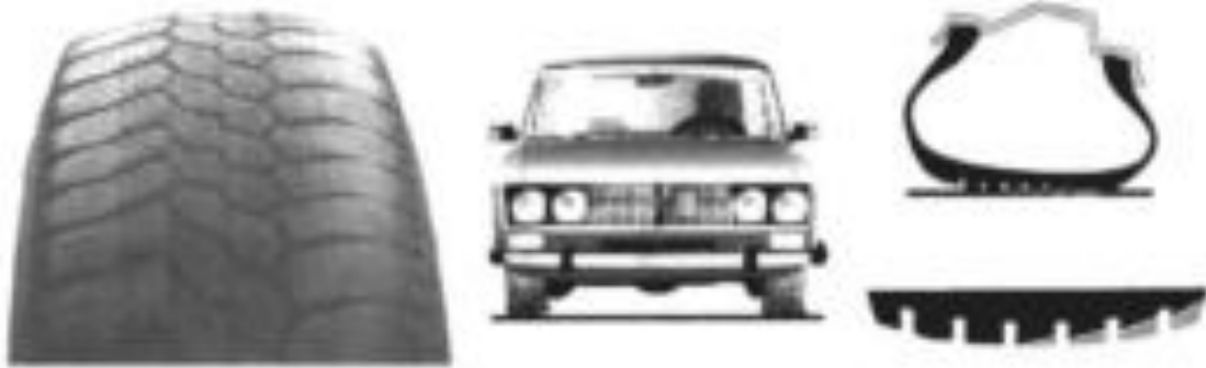
Рисунок 1.29 – Неравномерный износ протектора шины из-за нарушения углов установки колес (развала).
