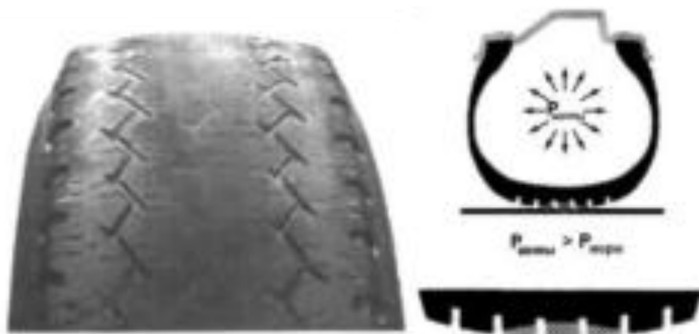
Рисунок 1.28 – Износ средней части протектора из-за езды с чрезмерной величины давления воздуха в шине.
