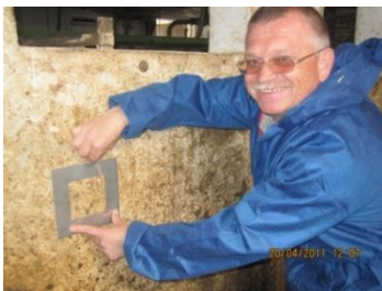
Рис. 1-2. Работа с пластиной для отбора проб с поверхностей (слева); оснащение рукояткой известной пластины и выполнение подвижной рабочей части
